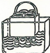
7. A seprő megfagyasztása a palackok nyakának hűtőfolyadékba merítésével
