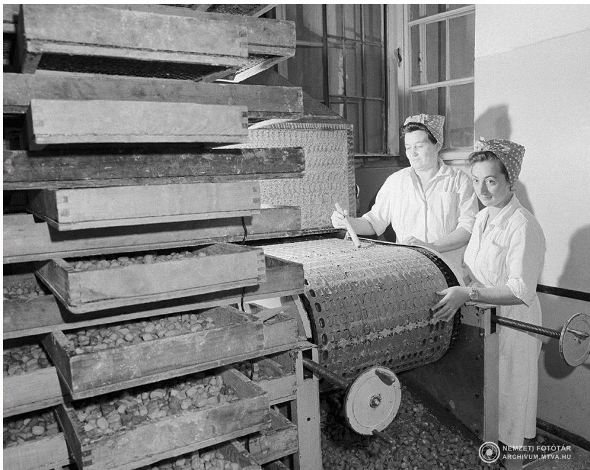
1960. október 15. A cukormasszából egy 20 méteres munkapálya végére lesz szaloncukor a Győri Keksz- és Ostyagyárban. A gyártásban jelentős újítást vezettek be, amely a termelést mintegy 40 százalékkal növeli, így ebben az évben a gyárból 129 mázsa szaloncukor kerül a fogyasztókhoz. MTI Fotó: Tormai Andor
